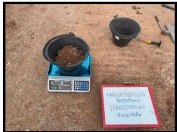
ภาพแสดงงานทดสอบความหนาแน่นชั้นรองพื้นทาง งาน Transition และ งานกำแพงกันดิน
