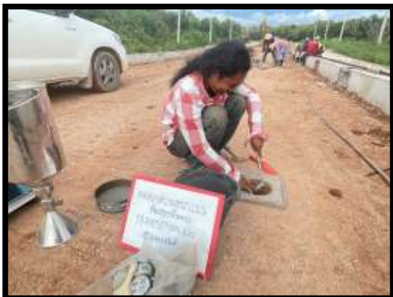
ภาพแสดงงานทดสอบความหนาแน่นชั้นรองพื้นทาง งาน Transition และ งานกำแพงกันดิน
