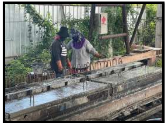
ภาพแสดงงานเทคอนกรีตค้ำหินปิดทางเท้า
