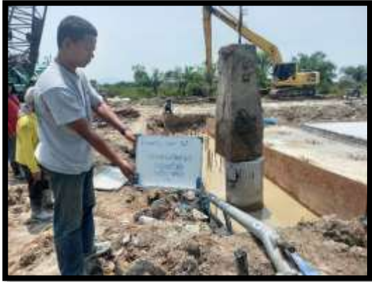
ภาพแสดงงานทดสอบกำลังรับน้ำหนักของเสาเข็มเจาะ ด้วย วิธี Dynamic P18 (ฝังเกาะ)
