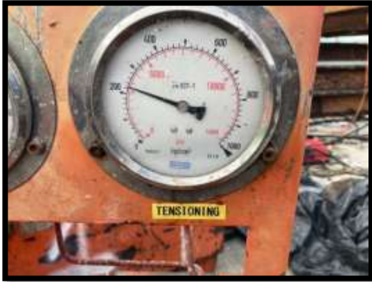
ภาพแสดงงานดึงลวดอัดแรงตามยาว งาน Balance P8 Type H
