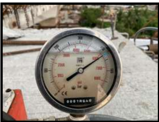
ภาพแสดงงานดึงลวดอัดแรงตามขวาง งาน Balance P8 Type I-I
