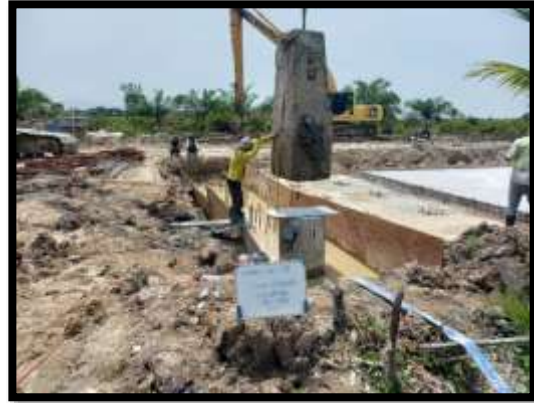
ภาพแสดงงานทดสอบกำลังรับน้ำหนักของเสาเข็มเจาะ ด้วย วิธี Dynamic P18 (ฝังเกาะ)
