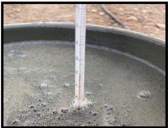
ภาพแสดงงานตรวจสอบคุณสมบัติปูนเกร้าท์
