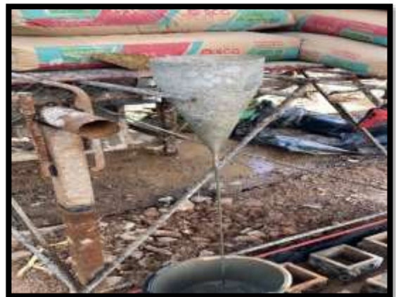
ภาพแสดงงานตรวจสอบคุณสมบัติปูนเกร้าท์
