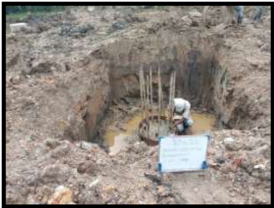
ภาพแสดงงานทดสอบความสมบูรณ์ของเสาเข็มเจาะ ด้วย วิธี Seismic P18 (ฝั่งเกาะ)
