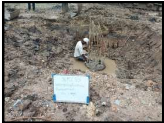
ภาพแสดงงานทดสอบความสมบูรณ์ของเสาเข็มเจาะ ด้วย วิธี Seismic P18 (ฝั่งเกาะ)
