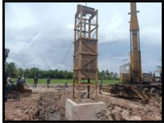
ภาพแสดงงานทดสอบกำลังรับน้ำหนักของเสาเข็มเจาะด้วยวิธี Dynamic P12 และ P13
