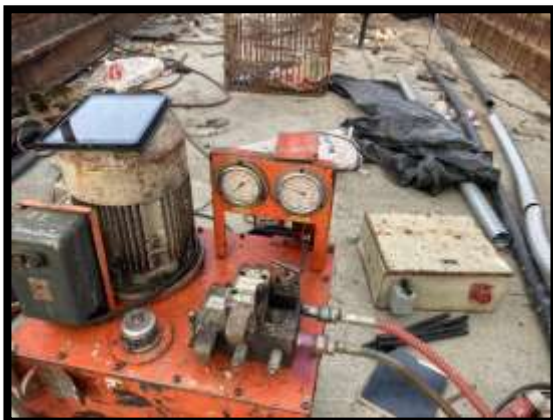
ภาพแสดงงานติดตั้งอัดแรงตามยาว งาน Balance P8 Type C-C
