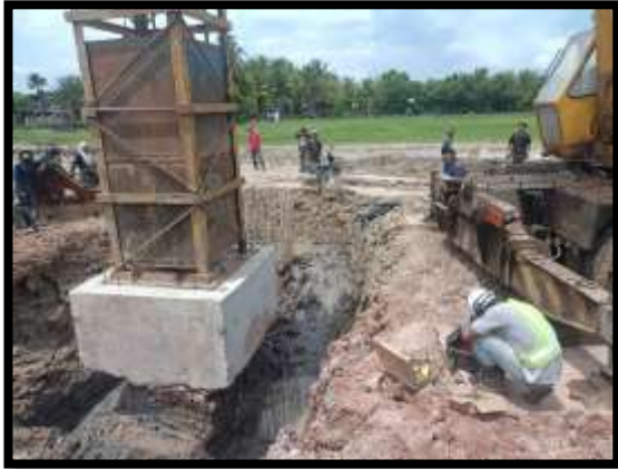
ภาพแสดงงานทดสอบกำลังรับน้ำหนักของเสาเข็มเจาะด้วยวิธี Dynamic P12 และ P13
