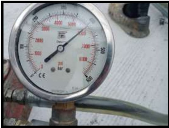
ภาพแสดงงานติดตั้งวัดแรงตามขวาง งาน Balance P9 Type D-D
