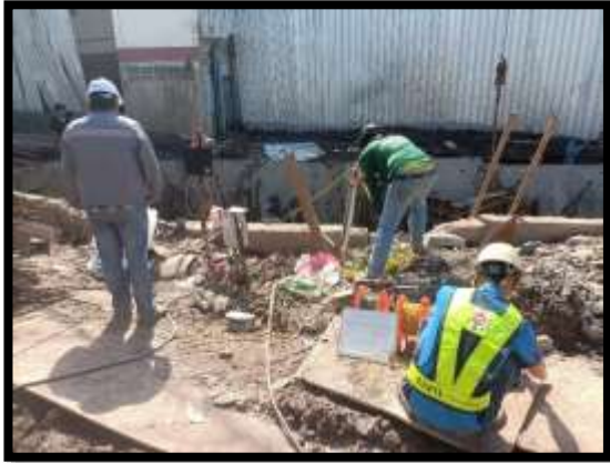
ภาพแสดงงานทดสอบเสาเข็มเจาะ โดยวิธี Sonic Logging Test ตำแหน่ง P8/6,P8/7,P8/8
