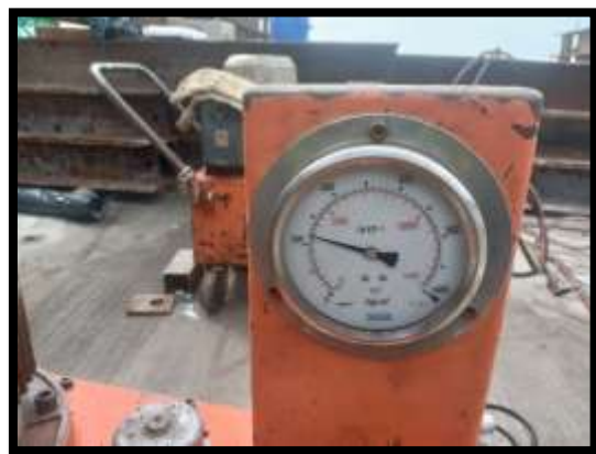
ภาพแสดงงานดึงลวดอัดแรง ตามยาว งาน Balance P9 Type A-A
