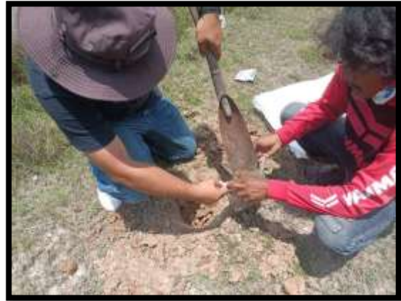
ภาพแสดงงานเก็บตัวอย่างดินเดิมฝั่งเกาะ เพื่อนำไปทดสอบ Control Test
