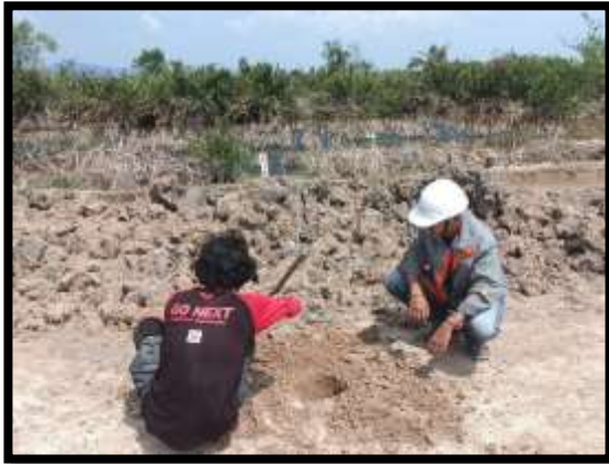
ภาพแสดงงานเก็บตัวอย่างดินเดิมฝั่งเกาะ เพื่อนำไปทดสอบ Control Test
