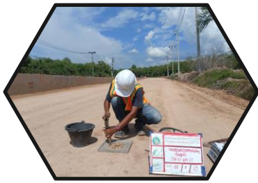
งานทดสอบความหนาแน่นชั้นรองพื้นทาง ความหนา 0.20 ม.
