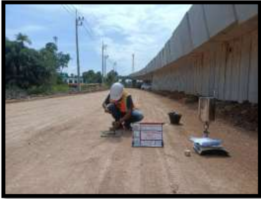
ภาพแสดงงานทดสอบความหนาแน่นชั้นรองพื้นทาง งานถนน Sta.๐+๕๕๐ ถึง Sta.๐+๗๐๐ LT
