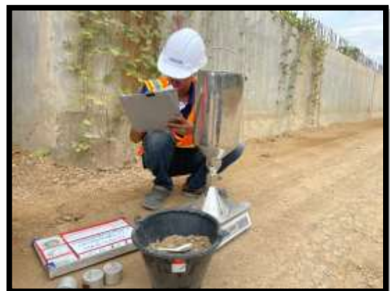
ภาพแสดงงานทดสอบความหนาแน่น ชั้นรองพื้นทาง ทางคู่ขนาน งานถนน Sta.๐+๕๒๕ ถึง Sta.๐+๗๐๐ LT
