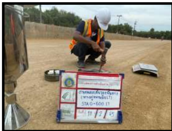
ภาพแสดงงานทดสอบความหนาแน่น ชั้นรองพื้นทาง ทางคู่ขนาน งานถนน Sta.๐+๕๒๕ ถึง Sta.๐+๗๐๐ LT
