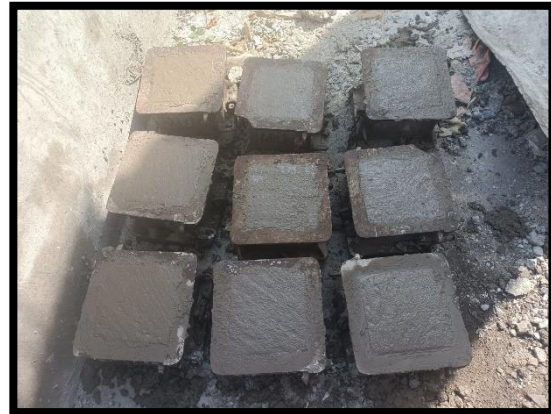
ภาพแสดงงานควบคุมคุณภาพคอนกรีต งานเสาเข็มเจาะ
