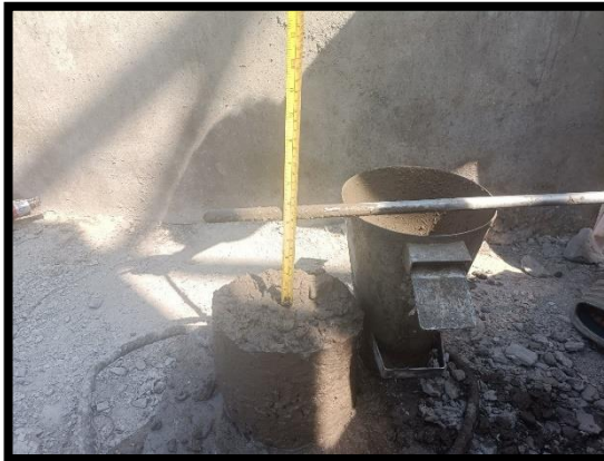
ภาพแสดงงานควบคุมคุณภาพคอนกรีต งานเสาเข็มเจาะ
