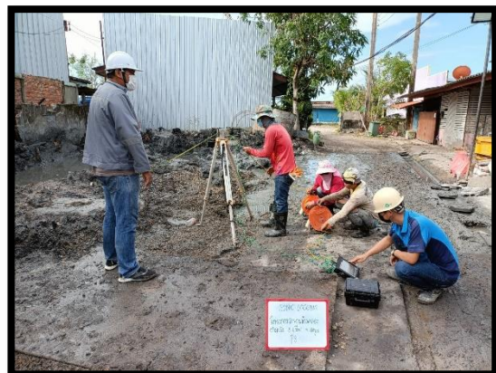
ภาพแสดงการทดสอบ Sonic logging เสาเข็มเจาะ ขนาดเส้นผ่าศูนย์กลาง ๑.๕๐ เมตร P๘
