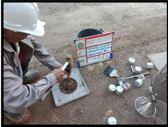
ภาพแสดงงานทดสอบความหนาแน่นของชั้นดินเดิม งานถนน Sta.๐+๗๐๐ RT
