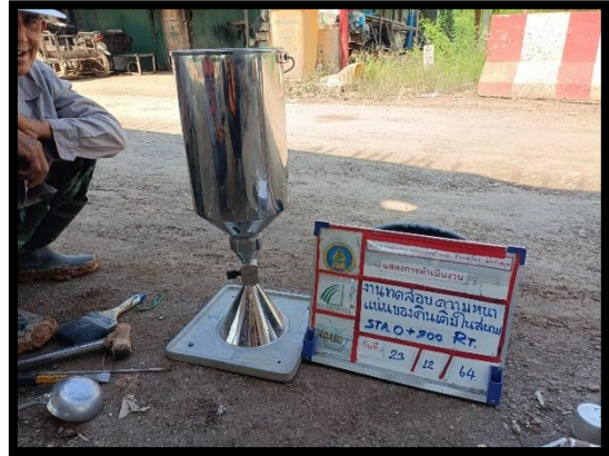
ภาพแสดงงานทดสอบความหนาแน่นของชั้นดินเดิม งานถนน Sta.๐+๗๐๐ RT
