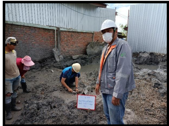
ภาพแสดงการทดสอบ Seismic เสาเข็มเจาะ ขนาดเส้นผ่าศูนย์กลาง ๑.๕๐ เมตร P๘
