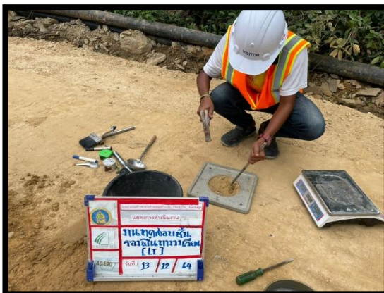
ภาพแสดงงานทดสอบความหนาแน่นของชั้นรองพื้นทราย ทางคู่ขนาน งานถนน Sta.๐+๓๕๗ ถึง Sta.๐+๕๐๐ LT
