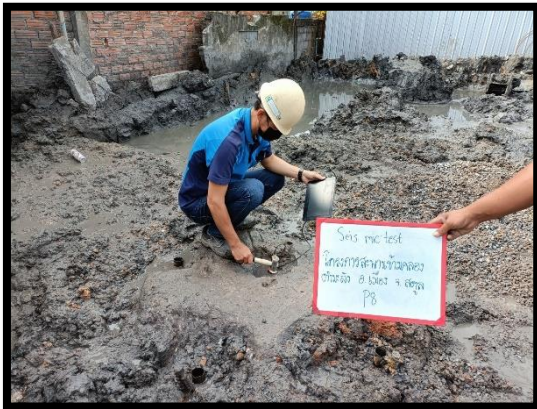
ภาพแสดงการทดสอบ Seismic เสาเข็มเจาะ ขนาดเส้นผ่าศูนย์กลาง ๑.๕๐ เมตร P๘
