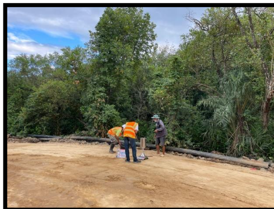
ภาพแสดงงานทดสอบความหนาแน่นของชั้นรองพื้นทราย ทางคู่ขนาน งานถนน Sta.๐+๓๕๗ ถึง Sta.๐+๕๐๐ LT
