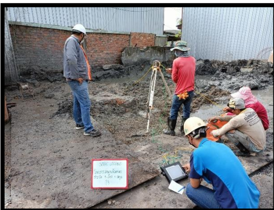
ภาพแสดงการทดสอบ Sonic logging เสาเข็มเจาะ ขนาดเส้นผ่าศูนย์กลาง ๑.๕๐ เมตร P๘
