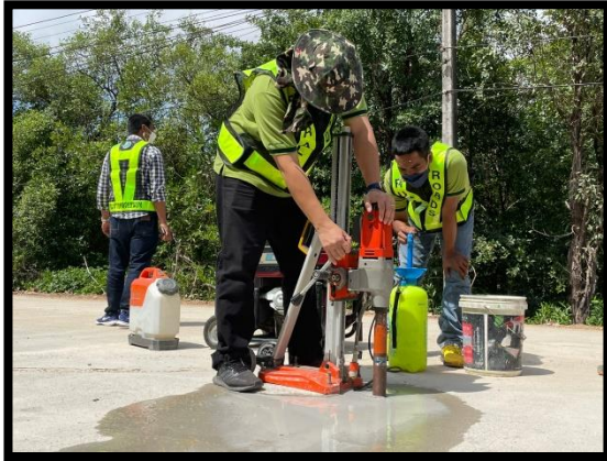
ภาพแสดงงานทดสอบความหนาคอนกรีต งานถนน Sta.0+0๓๐ และ Sta.0+๒๐๕ LT
