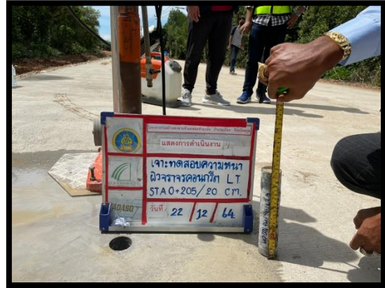
ภาพแสดงงานทดสอบความหนาคอนกรีต งานถนน Sta.0+0๓๐ และ Sta.0+๒๐๕ LT
