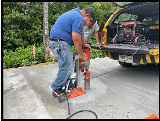
ภาพแสดงงานทดสอบความหนาแน่นคอนกรีต งานถนน Sta.๐+๐๔๕ และ Sta.๐+๒๕๘ RT
