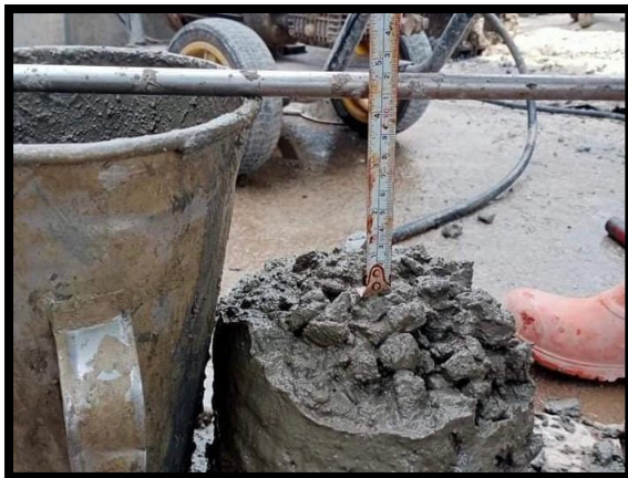
ภาพแสดงการทดสอบค่ายุบตัวของคอนกรีต
