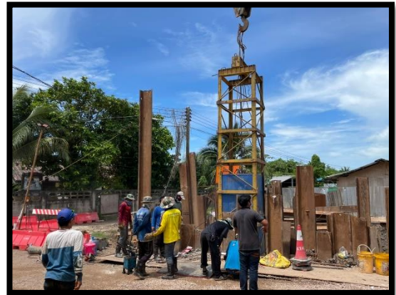
ภาพแสดงงานทดสอบกำลังรับน้ำหนักของเสาเข็มเจาะ ด้วยวิธี Dynamic (P๔)
