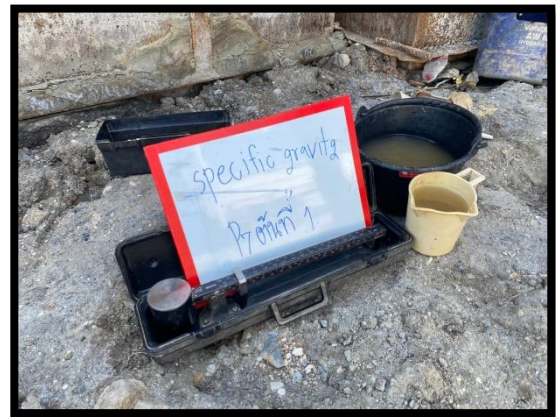
ภาพแสดงงานทดสอบสารละลายพวยหลุมเจาะ
