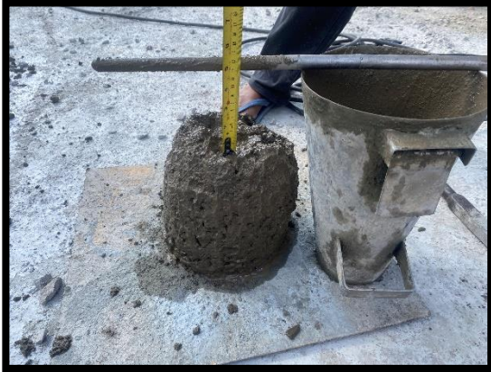
ทดสอบค่ายุบตัวของคอนกรีตงานเสาเข็มเจาะ
