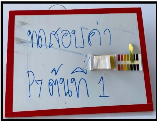
ภาพแสดงงานทดสอบสารละลายพวยหลุมเจาะ
