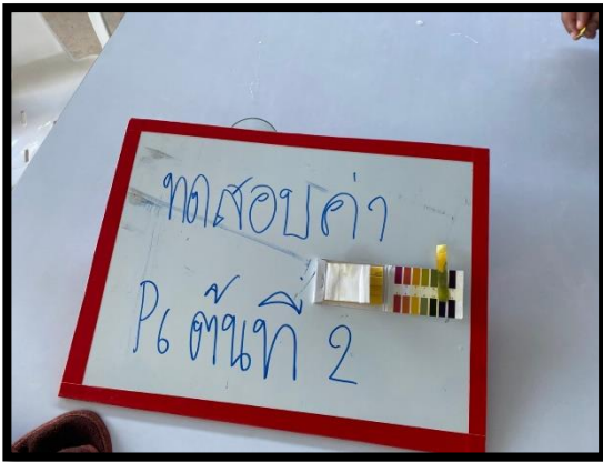
ภาพแสดงงานทดสอบสารละลายพยุงหลุมเจาะ
