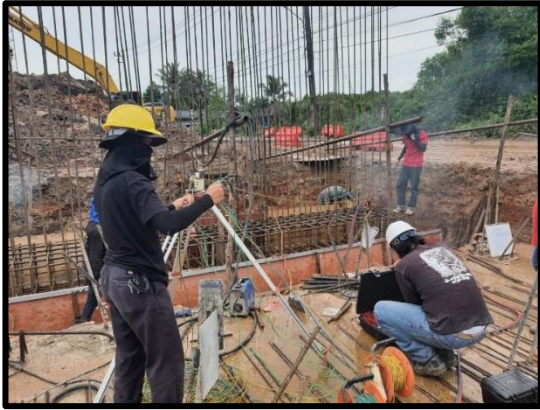
ภาพแสดงงานทดสอบความสมบูรณ์ของเสาเข็มเจาะ ด้วยวิธี Sonic logging
