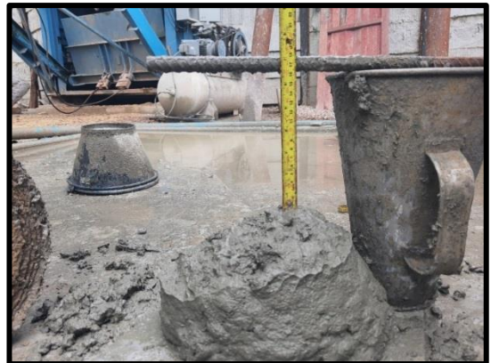
การตรวจสอบเหล็กเส้นเสริม, ทดสอบค่ายุบตัวของ คอนกรีตงานเสาเข็มเจาะ A ๑๔
