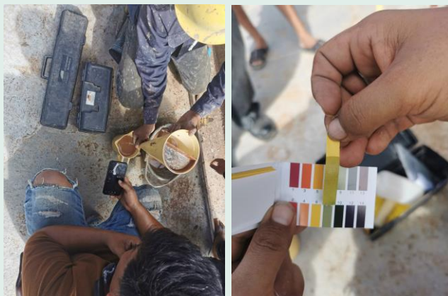
ทดสอบความชื้นและความเป็นกรดต่างสารละลายพวงหลุมเจาะ
